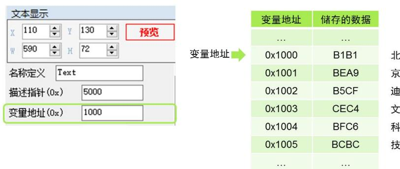
图 2.7 变量地址中数据的储存方式
