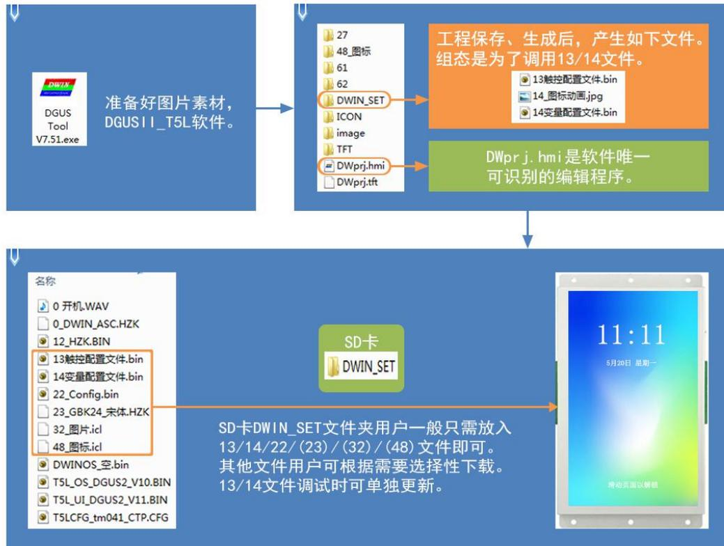
图 3.9DWIN\_SET 文件夹下载文件产生图
