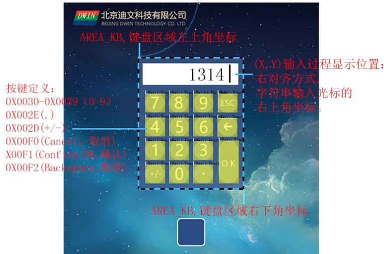
图 6.2 变量数据录入软件设置键盘坐标设置
